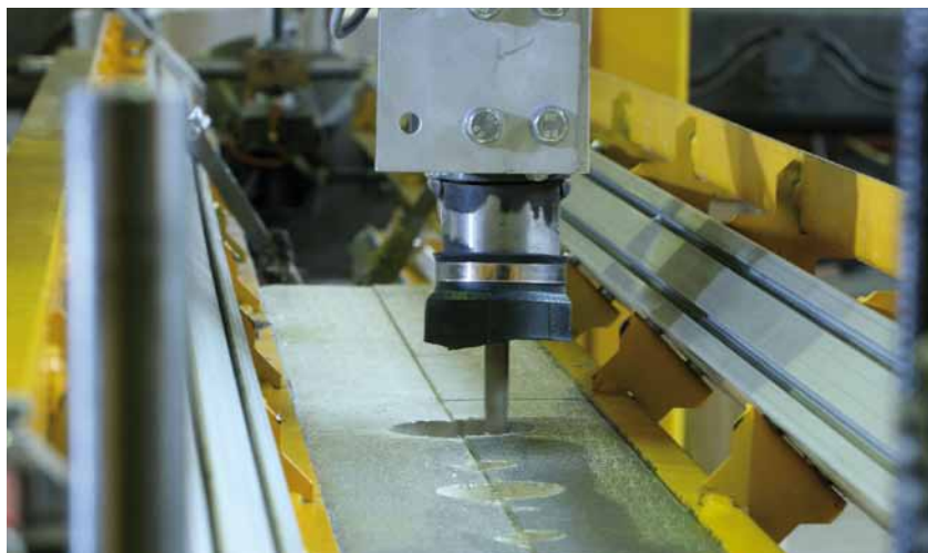
Passgenaue Herstellung von Isolierteilen auf CNC-Fräsanlagen Fabricarea corectă a pieselor izolante pe unitățile de frezare CNC
